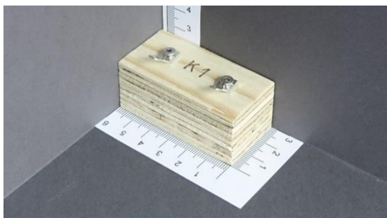
Abb. 1: links: fertig präparierte Probe mit 45°-Steckzunge (hier FSH Fichte) rechts: Zeichnung über den Versuchsaufbau
